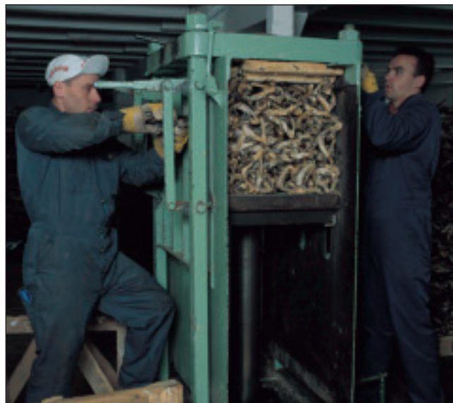
La pressa idraulica che serve per pressare le balle di stoccafisso.
